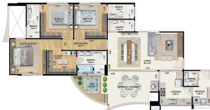
Figura 2 - Apartamento tipo – Edifício Contemporaneum prime residence
